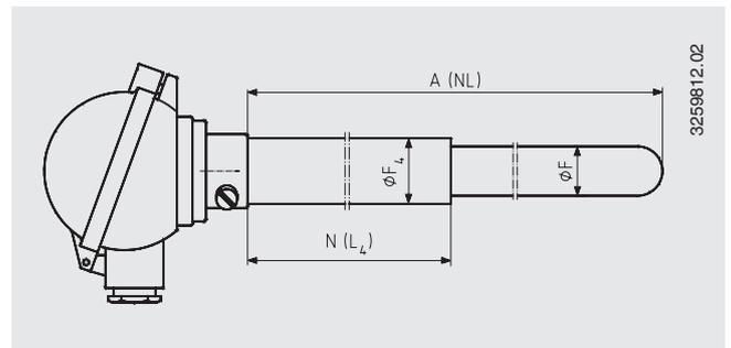
Abmessungen für Ausführungen mit Schutzrohr- $\varnothing < 24$  mm
