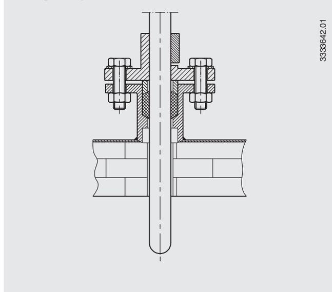
Montagebeispiel: Thermoelement mit Keramiksenschutzrohr
