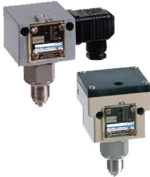
Für die Überwachung und Regelung von Drücken in Anlagen der chemischen Industrie, der Verfahrenstechnik und überall dort, wo der Druck von aggressiven Flüssigkeiten und Gasen überwacht werden muss, eignen sich die Druckschalter der Baureihe DNS. Alle Einzelteile des Fühlersystems bestehen aus hochwertigem Edelstahl (1.4571) und sind mit modernsten Verfahren ohne Zusatzwerkstoffe verschweißt. Der Druckfühler ist hermetisch gekapselt und enthält keinerlei Dichtungswerkstoffe.
