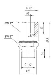
Die Manometer-Drehverschraubung ermöglicht das Positionieren von Druckmeßgeräten im Bereich von 360°.
