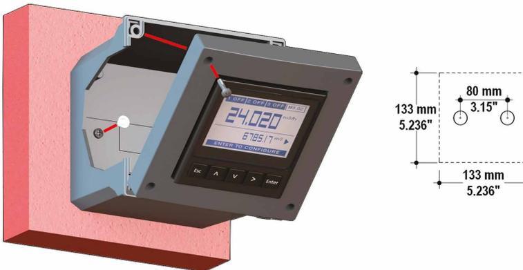
Für eine wasserdichte IP65-Installation ziehen Sie die frontseitigen Schrauben der Box sowie die Schrauben der wasserdichten Kabelanschlüsse und der innen montierten Kappen an den Schraubstellen fest.
