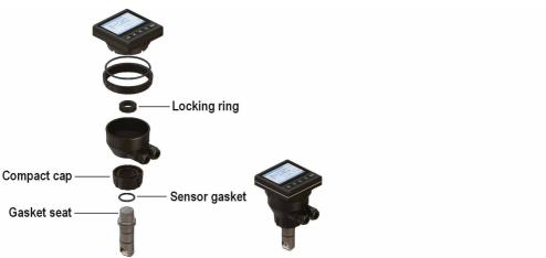
Das Kompakt-Montage-Kit (F6.KC1) beinhaltet den kompakten Kunststoffadapter mit Dichtung für wasserdichte IP65-Installationen, die Sensordichtung, die Kompaktkappe und den Sicherungsring.
