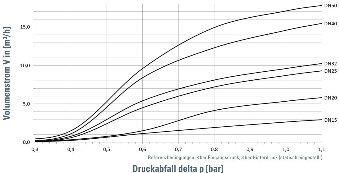
Auslegung über Durchflussgeschwindigkeit
