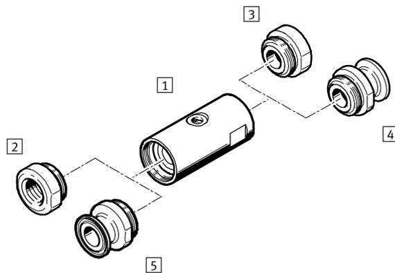
durch die Eigenspannung des Quetschelementes bzw. durch den Mediumsdruck. Das Ventil erlaubt es flüssige, staubförmige Medien, Feststoffe (Granulate) sowie Stoffgemische abzusperren. Der freie Durchgang im geöffneten Zustand sorgt für minimalen Strömungswiderstand und verhindert das Zusetzen oder Verstopfen.
