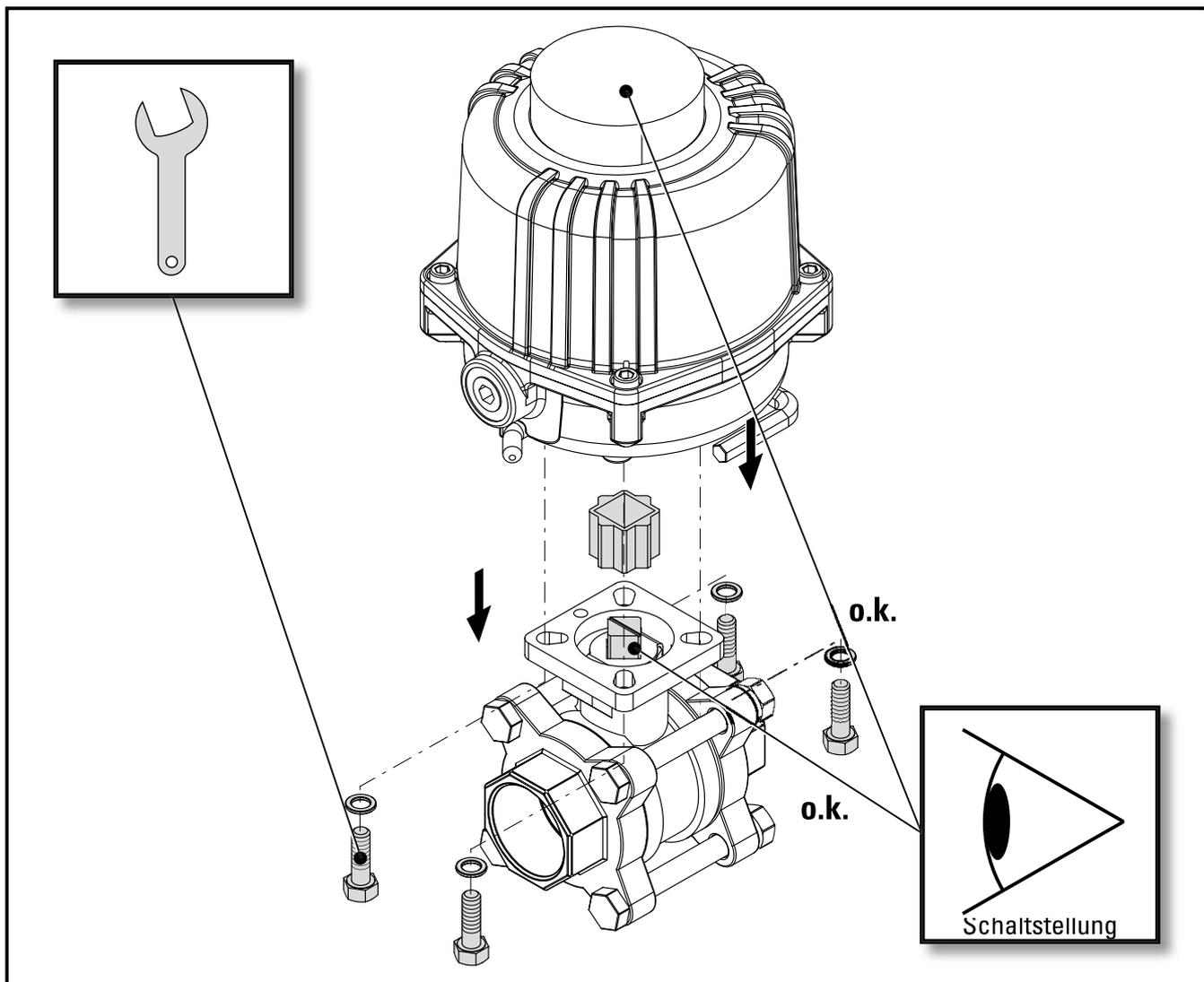
Abb. 6.1 - Einbau, direkte Montage
