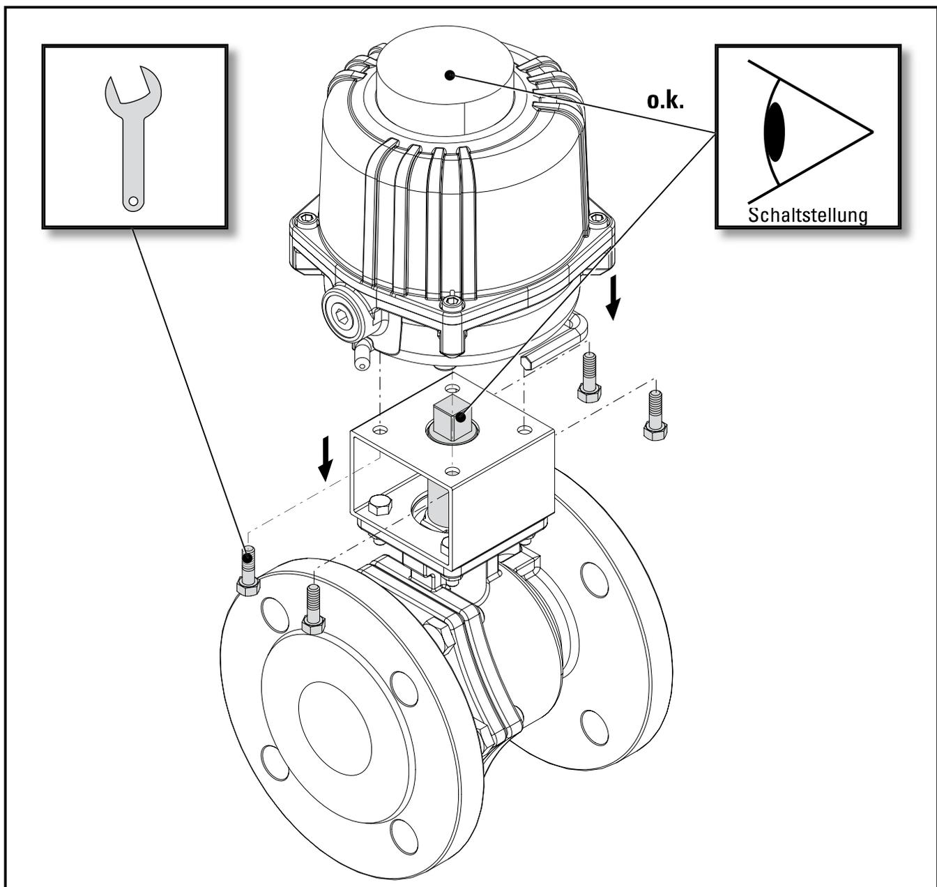
Abb. 6.3 - Einbau, Montage mittels Konsole und Spindel
