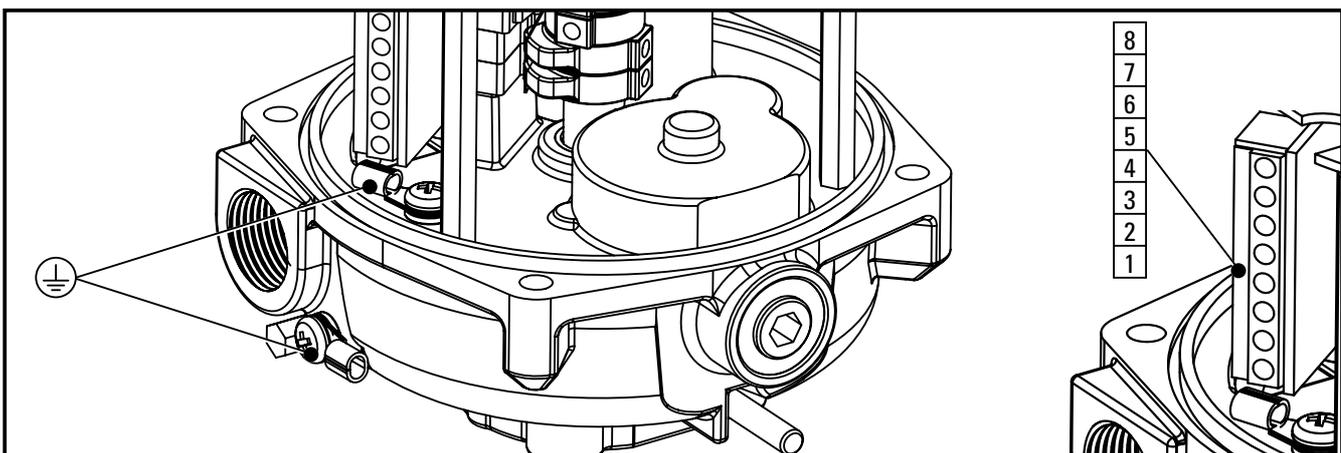
Abb. 6.5 - Elektrische Installation - Anschluss für Schutzleiter
