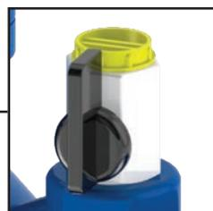
Prese per il controllo della pressione assoluta e differenziale nella zona di monte e intermedia. Insieme con lo strumento ECO3 TEST permettono la verifica della funzionalità del disconnettore.
