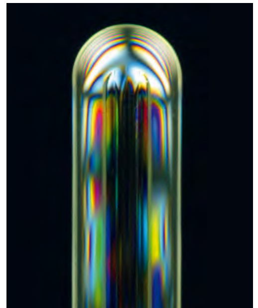
Thermisch vorgespannte (gehärtete) MAXOS® Gläser unter polarisiertem Licht
