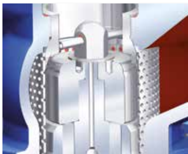
Strömungsteiler zur Geräuschreduzierung
