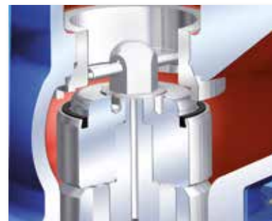
Kegel mit PTFE-Weichdichtung (max. 200°C, nur für Standard-Kvs-Werte)
