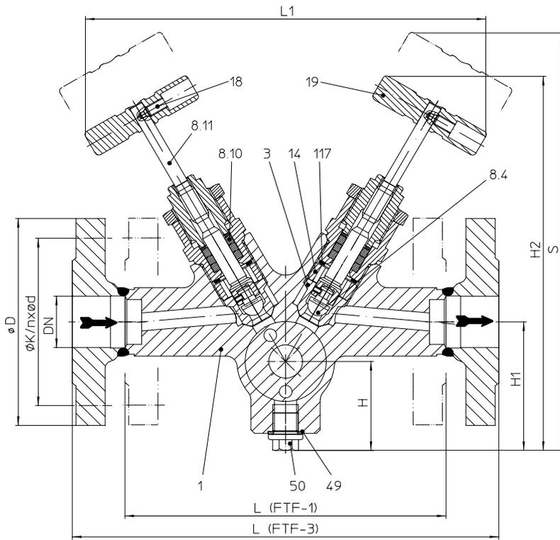
Absperrentil mit Stopfbuchsabdichtung (Zufluss von rechts)
