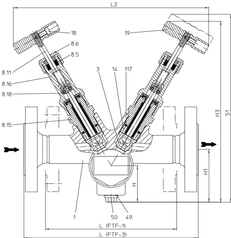
Absperrentil mit Faltenbalgabdichtung (Zufluss von rechts)
