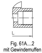
Fig. 61A...2 mit Gewindemuffen
