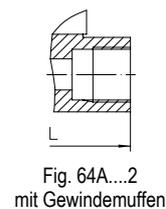
Fig. 64A...2 mit Gewindemuffen
