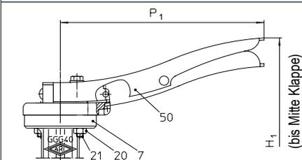
Zur leichteren Bedienbarkeit empfehlen wir ab DN125 den Aufbau eines Getriebes, insbesondere bei unzugänglichen Einbauverhältnissen (siehe unten).
