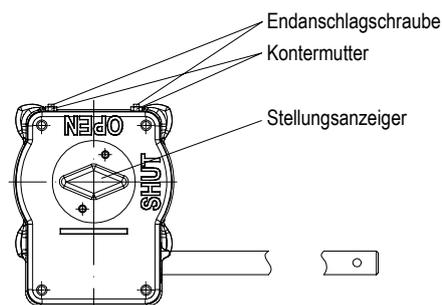
Die ZU-Stellung ist durch eine justierbare Endanschlagschraube auf  $\pm 5^\circ$  verstellbar.
